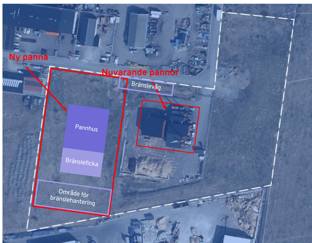
Figur 6. Preliminär placering av nytt pannhus (röd ram), bränsleficka och område för bränslehantering (alternativ A).
