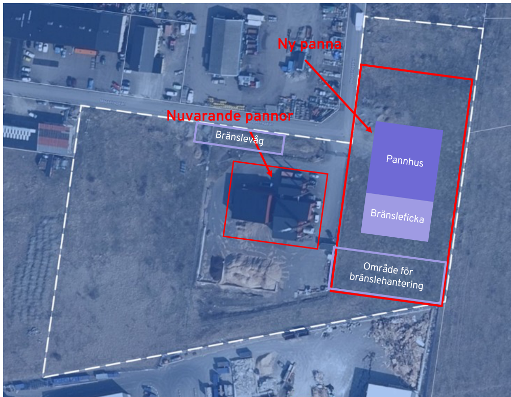
Figur 7. Preliminär placering av nytt pannhus (röd ram), bränsleficka och område för bränslehantering (alternativ B).
