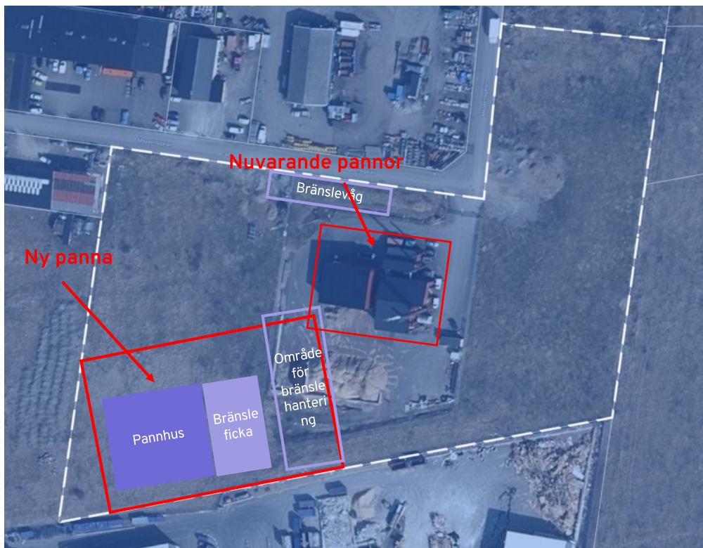
Figur 8. Preliminär placering av nytt pannhus (röd ram), bränsleficka och område för bränslehantering (alternativ C).
